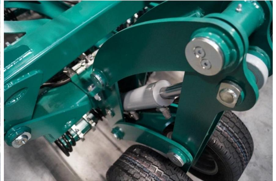
**HILFSFAHRWERK / STÜTZRADKOMBINATION mit Parallelogramm gestützter TANDEM-Bereifung 55cm Ø, Reifen jeweils knapp 20cm breit, 3,5 bar, hydraulisch einstellbar:**
