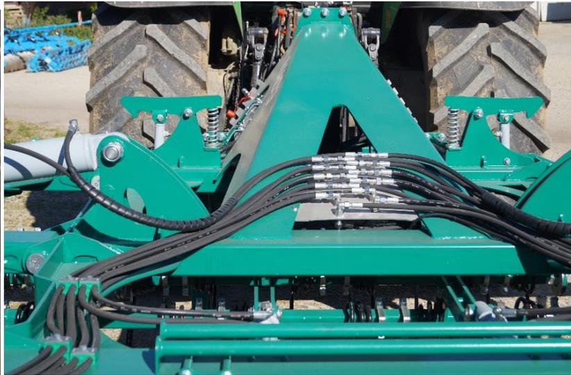
160 Meter Hydraulikleitungen (9,2m)
