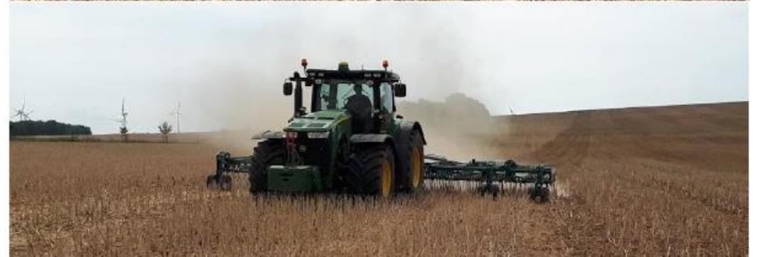
**ABBILDUNG: jede zweite Zinkenreihe ist nach oben eingefahren.**
