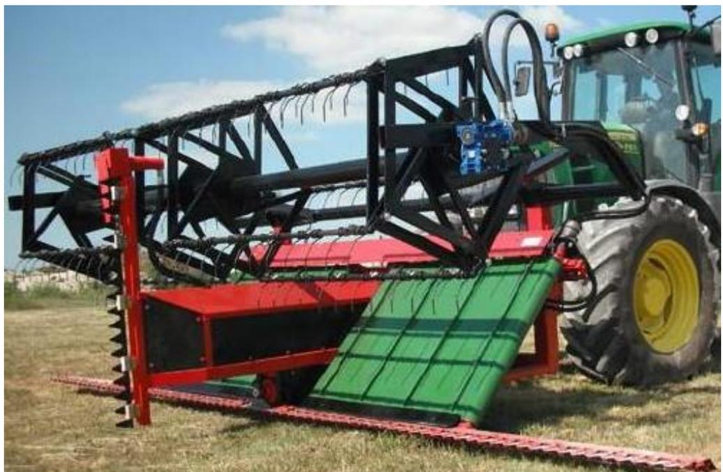
**BEDARF: maximal 45 lt./min Hydraulikölförderung**
