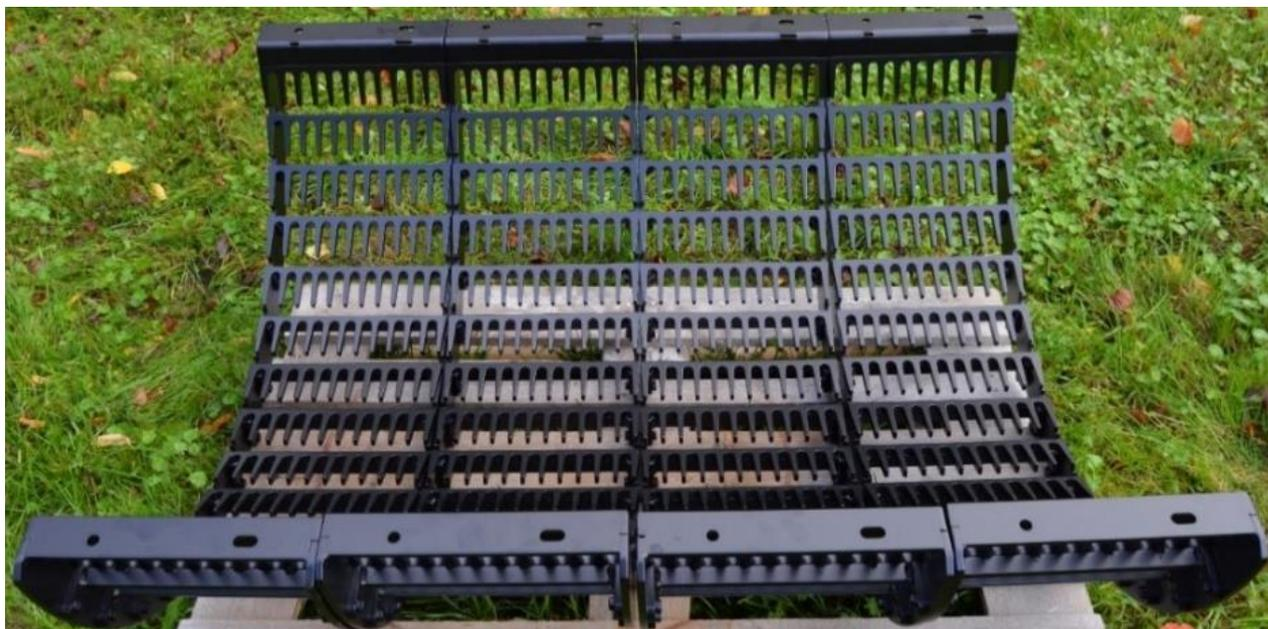
**HIGH-SPEED Restkornabscheidung auch bei Getreide; Raps und anderen Fruchtarten, Mengenmässige und qualitative Leistungsverbesserung insbesondere bei grobvolumigem, restfeuchtem bis restgrünem Halmgut.**
