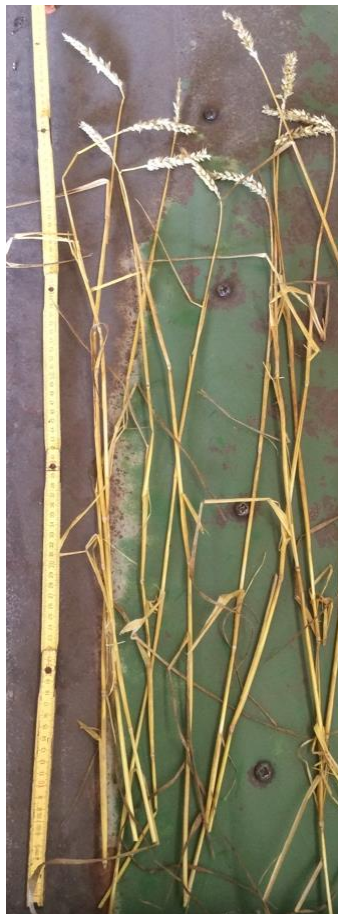
ca. 80% intaktes Stroh mit AB.SFÄP & AB. GDL AB. Pressgitter Korb
