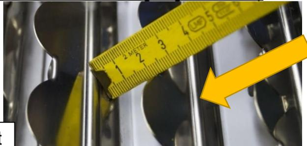
Durchgehend geschlossener, längerer und steilerer WINDFANG. Senkrechter, breiter Körner Durchsturzspalt. Angewinkeltes WINDKANAL-BLECH:
