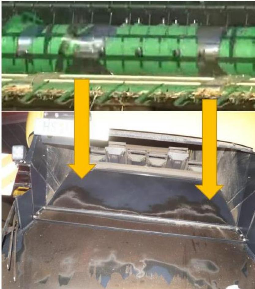
**Problematik, s. Fotos links:** => Bildung links- und rechts von Presssträngen (-Fladen) in der Schneidwerksmulde vor dem Schrägförderer. Diese, einmal eingeleitet, setzen sich bis zuhinterst fort, um dort dann Körner-Verluste heraus zu transportieren. (=> Fladenbildung andernfalls verstärkt zur Mitte hin, hier der Kürze halber nicht aufgeführt).
