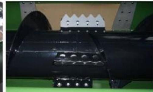
**Zu oben:** Setzen Sie –oder ein Nachbar- ein neues Schneidwerk ein? Fotografieren Sie den Farbabrieb an Ihrer Schnecke, in der Mulde darunter vor dem Schrägförderer, sowie den Farbabrieb am Eingang des Schrägförderers:
