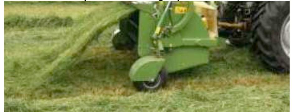
Höchster Schnellst-Durchgang dank abnehmbarem Frontblech an der Basis. Damit Maximaler Durchgang in der Höhe, Rotor IST im Durchmesser der Größte. (Je kleiner der Rotordurchmesser, desto mehr schiebt das Gerät das Halmgut nach vorne, wenn es mal dick auf Schwad liegt).
