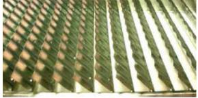
Das oben abgebildete Lamellenobersieb AB.28.I, da Produktion zu aufwendig (Überlappung der Lamellen), wurde ab 2016 durch ein AB.41.I oder AB 36.I ersetzt.
