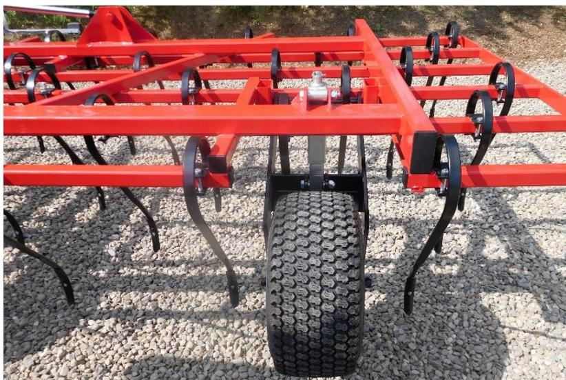
1280kg schwer: einfacher Hydraulikkreislauf zum rauf- und runterklappen.
