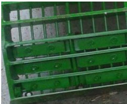
Vorne sind 3 Stück AB-GDL eingebaut: 6mm dicke, hochgelegte Korbdrähte; 24mm breite Spaltöffnungen
