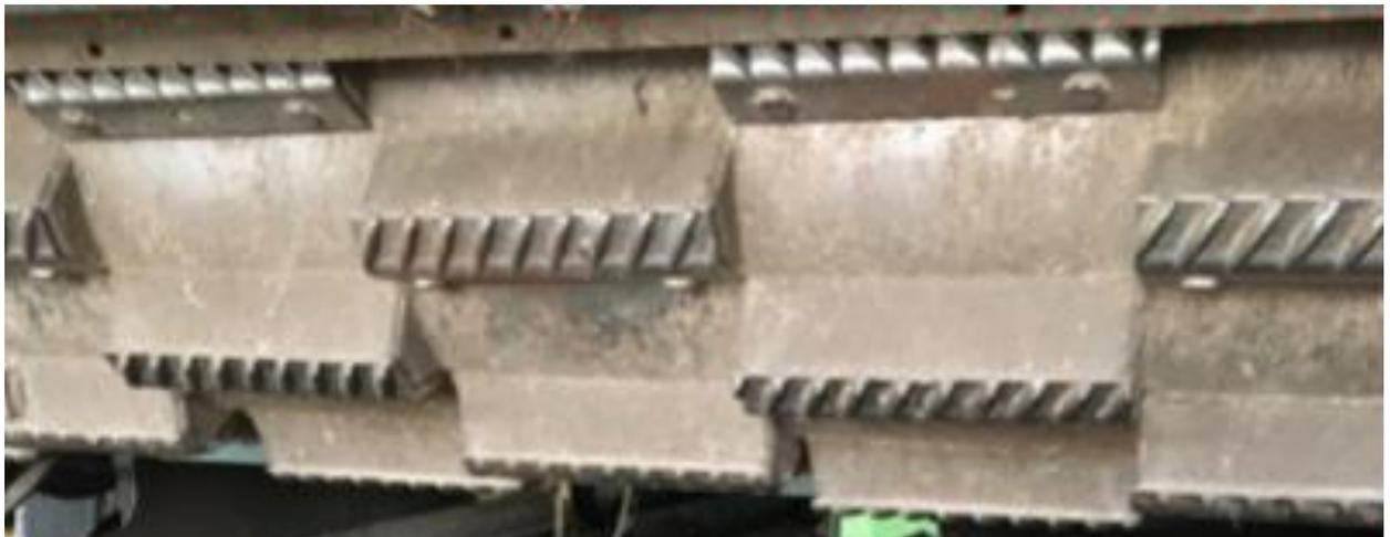
**Gewuchtet! Mit versetzten, abschraubbaren Dreschleisten: 60cm Durchmesser durchzugsstark, geschlossen, 400 kg Schwungmassen = Schwungrad verstärkt.**
