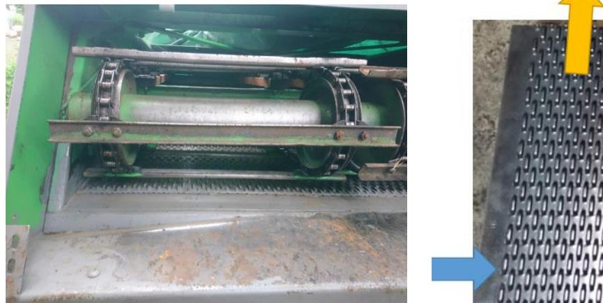
bis 100% der Ähren sofort auflösen – keine Drusch-Verzögerung mehr! Im Verbund mit den AB.GDL (s.u.) massive Kornabscheidung sofort am Eingang des Dreschkorbes. Im Verbund reduziert beides und eliminiert Schüttlerverluste, zusammen den AB. Feder-Schüttlergabeln.
