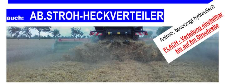
Feuchtes und restgrünes Stroh von Schneidwerken bis 12,4m, auf Flachschwade bis 8 Meter Ablagebreite, verteilen. Zum besonders schnellen nachtrocknen:
