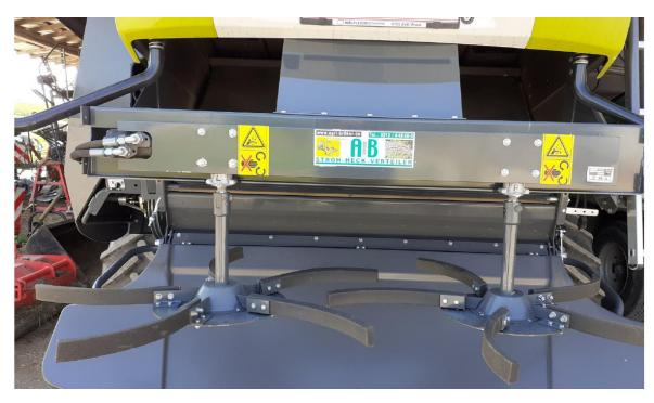
Dieses Foto zeigt die ab 2020 verbaute Standardlösung mit, pro Dreheinheit, 5 aufgerichteten Verteilriemen-Gummi's.
