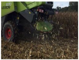
FOTO LINKS: "Maisrückstände/LIESCHEN Rückverteilung bei 14% Kornfeuchte auf 7 Meter Erntebreite möglich: wir sparen jetzt erhebliche Verschleißkosten am Häcksler" – LU F., 2017
