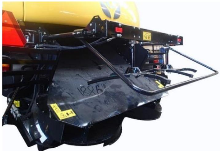
**AB.HECK.ZETTER TYP X:** => Mindestbestellmenge pro Produktionscharge: 5 Stück => Für CLAAS Tucano u.a. Mähdrescher mit mechanischem Heckriemenantrieb, welche eines eigens dafür zu schaffenden Hydraulikantrieb bedürfen, sollte dieser Zetter hydraulisch angetrieben werden.
