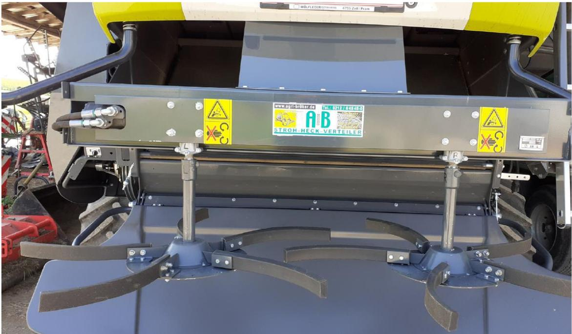
Dieses Foto zeigt die ab 2020 verbaute Standardlösung mit, pro Dreheinheit, 5 aufgerichteten Verteilriemen-Gummi's.
