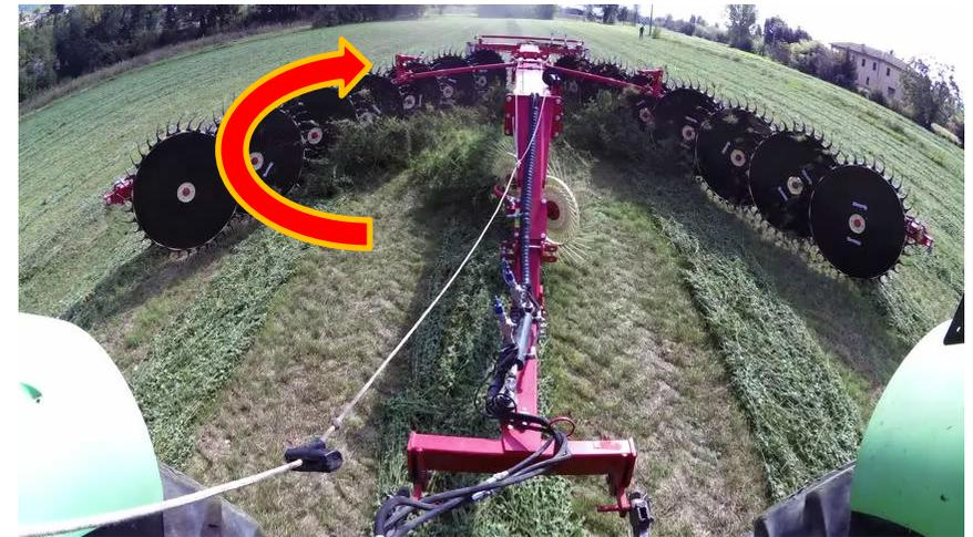
Das AB.XXL-PGS Sternradschwader Halmgut wird im 180° Winkel von unten nach oben, hoch und dann seitlich versetzt Wende geschwadet: die Bodennahe feuchte Schicht kommt nach oben um schnell nachzutrocknen.
