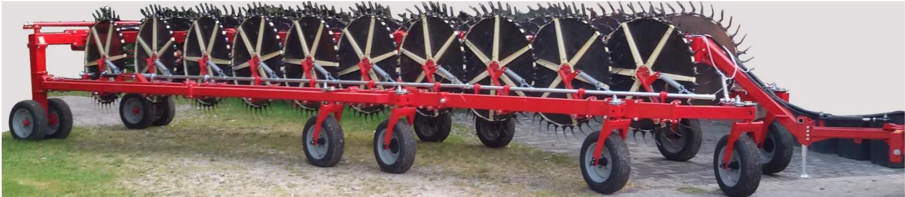
12,1 Meter Straßentransport lang, fertig zusammengebaut:: 3600 kg Gesamtmasse (inkl. 2 zentraler Schwadräder, ohne Gummiflex-Zinken, wie auf den Fotos auf Seite 4 ersichtlich) - sofort lieferbar mit bereits eingebauter WABCO Druckluftbremse / Tristop-Standbremse (ca. 200 geschätzte Kilogramm zusätzliches Gewicht, nach Straßenverkehrs konformer Aufrüstung), z.Zt. mit 1. TÜV-Gutachten.
