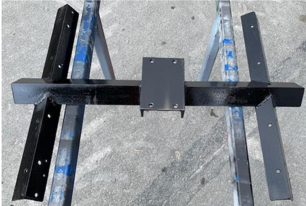
„Wir haben uns das links abgebildete Vibrationsgestell selber gebaut (hier noch ohne AuflastfüÙe). Der –von uns etwas größer gewählte- Motor vibriert wie der Teufel, selbst der Mähdrescher vibriert mit! Das Abtanken hat super funktioniert, der Austrag war sehr gut, bei allen Fruchtarten wie Kümmel, Fenchel und Grassamen. Ohne diesen Rüttler wäre das Ausleeren des Korntankes nicht gegangen.“ Landwirt Herr Rank – Bayern. Weiter-Bericht zuunterst (\*)
