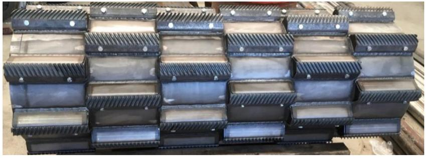
**NEUE AB. KOMPAKT-DRESCHTROMMEL, arbeitet einem Schwungrad ähnlich.** Einsatz mit geringerer Drehzahl: Ähren massiger und zügiger auflösen, Druschgut schneller entleeren. Höhere Druschvolumina konstanter durch einen auch stärker geöffneten Dreschspalt durchziehen. Ideal auch für Rundstabkörbe. Unterstützten auch schonenden Maisdrusch bei reduzierter Drehzahl. Synergie mit dem Agri-Broker Wirtschaftswunder, siehe Lösungen zur Problemzone 2.
