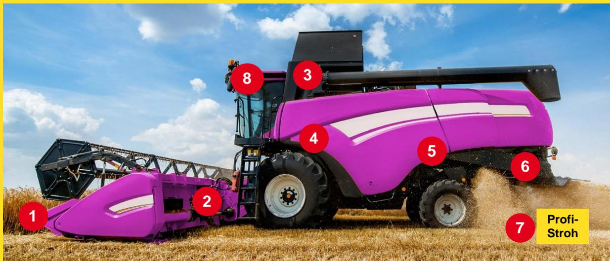
Auch der Motor gewinnt Leistungsreserven: seitlicher Gutfluß in 1 wird stehend bis zum Zentrum der Schnecke geleitet und dort von 2 Zwangsführungsleisten/ZFL gepackt..
