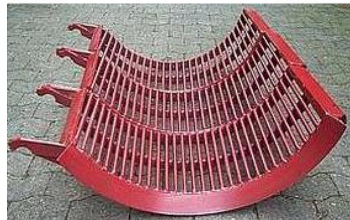
**OPTION II - AB.UGRK UNIVERSAL-GLEITROSTKORB** u.a. zum Abrollen von Maiskolben
