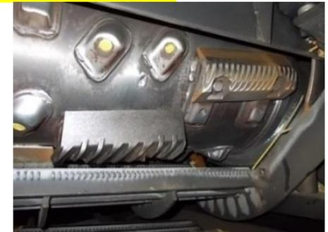
**OBEN - Immer links!** Agri-Broker HIGH SPEED DRESCHBACKEN mit 8 breiten = schonenden Durchzugskanälen
