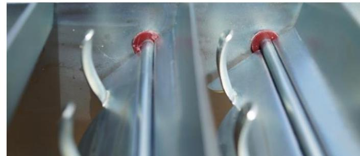
Diese so ausgestatteten Agri-Broker Lamellensiebe minimieren /eliminieren seitlich den Draht Verschleiß und reduzieren den Schüttelstreß, der auf den gesamten Draht ausgeübt wird.
