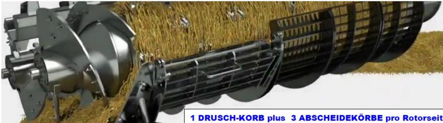
**1 DRUSCH-KORB plus 3 ABSCHIDEKÖRBE pro Rotorseite (x2)**
