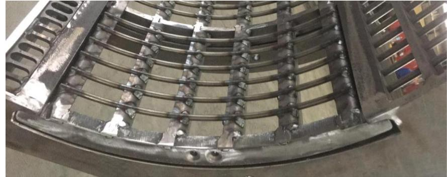
Wir empfehlen die Montage von mindestens 2 Stück AB.GDL /Gegendreschleisten, am Hauptkorbeingang:
