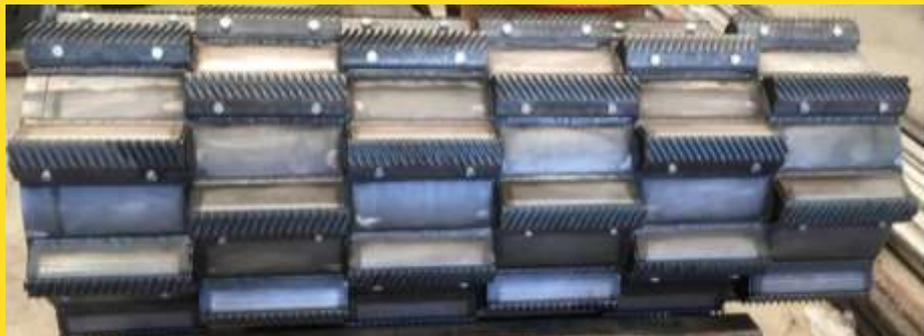
U. a. für Deutz-Fahr/DF 6-Schüttler Mähdrescher. Praxis erprobt und mit Zertifikat gewuchtet! Beispiel DF-Trommel: 48 = 8x6 versetzte, abschraubbare Dreschbacken; Trommel-Durchmesser: 60cm & 400 kg Schwungmasse, treiben einen unaufhaltsamen Durchzug an, ähnlich einem Schwungrad.
