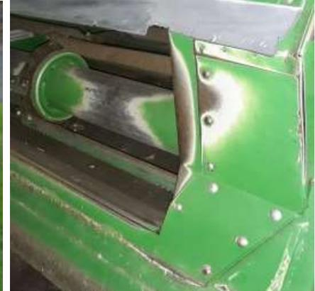
**LIMITS!** - Erntegutmengen werden am Ende defekter Wendel und zurückgehaltenen Abstreifleisten nicht mehr zwangsgeführt, sondern ausgehoben um daraufhin auf die seitliche Schrägförderabgrenzung geklatscht zu werden (s.a. Foto oben).
