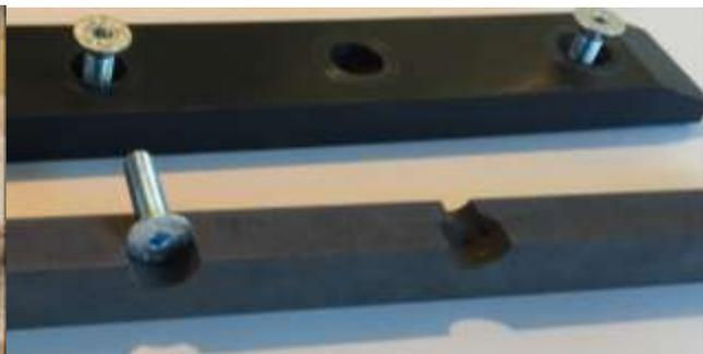
**Gleitplättchen** (Foto oben links, s. Pfeil) und bei Förderleisten mit zu geringem Abstand zum Förderboden werden gleichzeitig **Gleitkufen** (Foto oben recht: 5cm breit, 2cm hoch, 40cm lang) verbaut.
