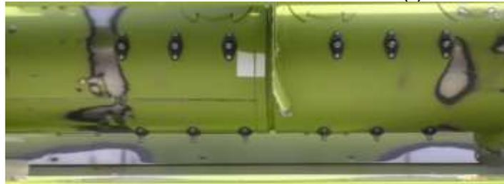
(\*) - **Farbabriebe zeigen** seitlichen Lastabbruch an, am Schneckenwendel-Ende. Das zwangsgeführte Erntegut erleidet eine Teilbremsung. Bis an die ersten Finger anstoßend werden seitlich, links und rechts, Überlast-Wülste gebildet, um erst daraufhin von den Fingern abrupt hochgeschoben zu werden. Erst dann erreichen diese Wülste den Schrägförderer:
