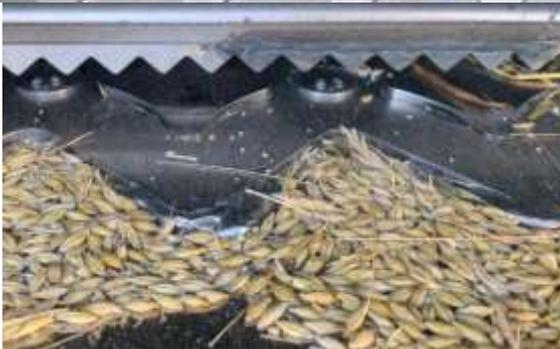
**IHRE VORTEILE:** Entzerrt den Druschgutstrang & sortiert das Korn nach unten. Löst leicht dreschende Körner schonend aus der Ähre. Entgrannt reife Grannen. Kein Bruchkorn. Hohe Abscheideraten über AB. Mähdrescher-Gleitrostkörbe / Vorkörbe (s. S. 25). Nach dieser Vorarbeit: weiter Dreschspalt mit geringerer Trommel Drehzahl !
