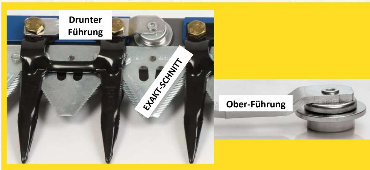
**DER AUFBAU:** Ab 6 m Schneidwerksbreite wird abwechselnd, zwischen zwei getrennten Führungsplatten und je zwei Doppelfinger-Breite, immer eine **Ober- und danach eine Drunter- AB. RLF** montiert. Ein 6 m Schneidwerk wird z.B. **mit 11 Obergriff Rollen ausgestattet**. - Führungsplatten dienen **vorrangig als Distanzhalter**, 4-Loch: 256mm; 3-Loch: 180mm; 2-Loch: 104mm.
