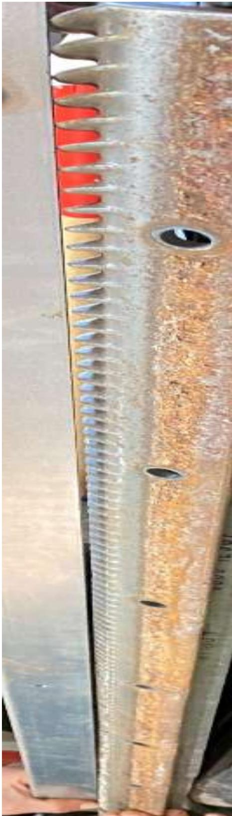
**LIMITS!** =>Farbabriebe zeigen ÜBER-PRESS-DRUCK an, sei es auf den Schneckenzyylinder als auch auf den Förderboden ab Schneckenwendelende (\*)
