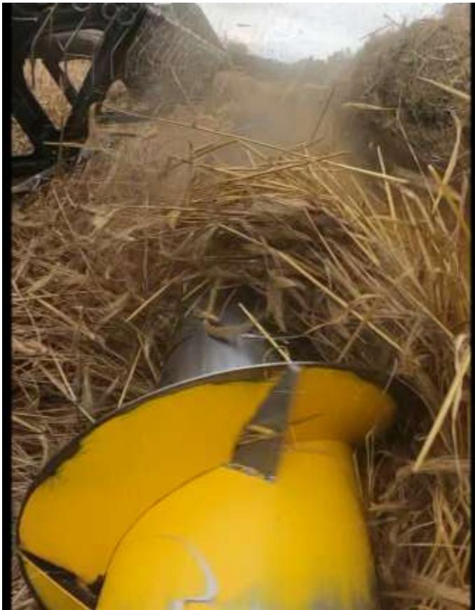
**LIMITS!** Ungleichmäßigen Vorschub gibt es bei mangelnder = diskontinuierlich arbeitender Zwangsführung von beiden Seiten des Schneidwerkes. Der Erntegut Vorschub über die Schneckenwendel, kommt unter der rückwandigen Abstreifleiste immer wieder kurz zum Stocken. Dieser Fortfuhrbereich ist unter den Schneckenwendelendkanten eckig und nicht radial, s. nächste
