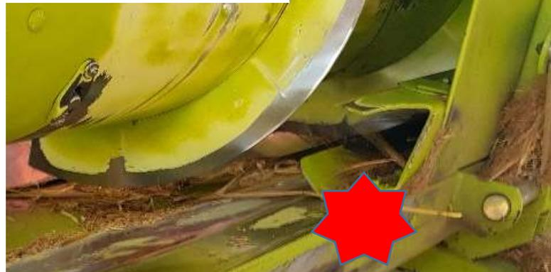
**LIMITS!** - Bei dem gelb lackierten Mähdrescher machen beide seitlich hochgeklatschten Erntestränge wohl einen Looping, um die Lackierung der Schrägförderer Aufzugswelle, beide Male, in der Mitte abzuschmirgeln.
