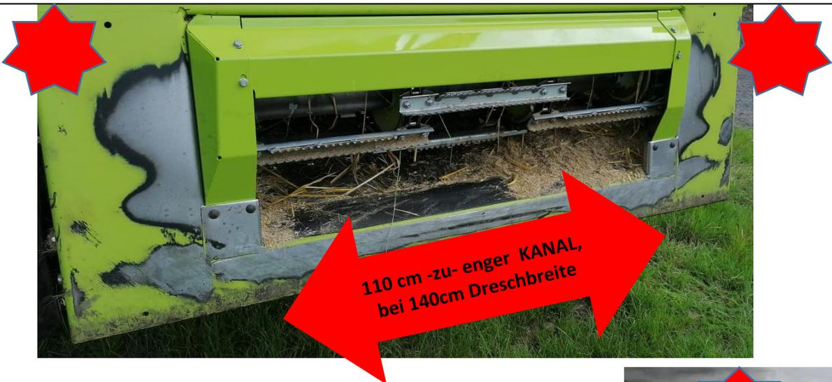
Das Aufklatschen von Überlasten ist so massiv, dass die Seitenabdeckbleche schnell verschleifen - das Foto oben zeigt die daraufhin bereits montierten NEUEN Bleche. -Bei anderen Schneidwerken, s. Foto rechts, dringt das Erntegut zwischen den Förderleisten auf die Umlenkwellen massiv durch.
