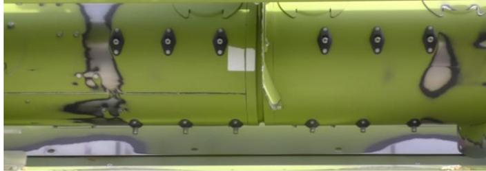
(\*) – **Diese Farbabriebe zeigen** Lastabbruch ab SWE an. Das zwangsgeführte Erntegut erleidet eine Teilbremsung. Erst wenn an dieser Stelle auf die Schnecke Überlastwülste aufgepresst werden, nach mehrmaligem Umlauf der Schnecke schafft es der eigentlich zu schmale Finger diese dem Schrägförderer zuzuschieben:
