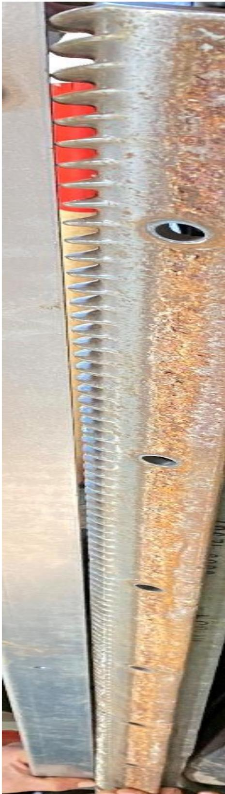
**LIMITS A:** => **Farbabriebe zeigen ÜBER-PRESS-DRUCK** an, sei es auf den Schneckenzyylinder, als auch auf den Förderboden ab Schneckenwendelende /SWE (\*)
