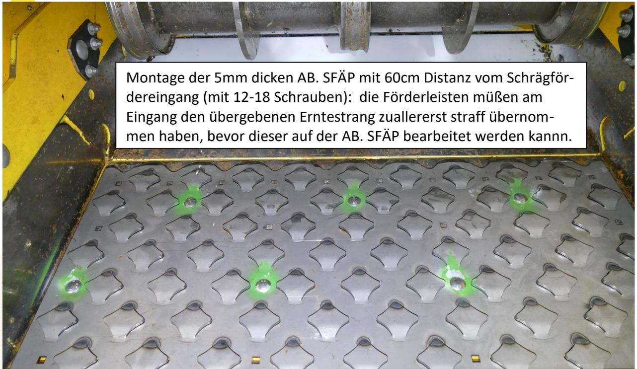
Montage der 5mm dicken AB. SFÄP mit 60cm Distanz vom Schrägförderereingang (mit 12-18 Schrauben): die Förderleisten müssen am Eingang den übergebenen Erntestrang zuallererst straff übernommen haben, bevor dieser auf der AB. SFÄP bearbeitet werden kann.
