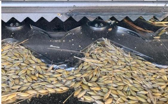
**IHRE VORTEILE:** Entzerrt den Druschgutstrang & sortiert das Korn nach unten. Löst leicht dreschende Körner schonend aus der Ähre. Entgrannt reife Grannen. Kein Bruchkorn. Hohe Abscheideraten über AB. Mähdrescher-Gleitrostkörbe / Vorkörbe (s. S. 25). Nach dieser Vorarbeit: weiter Dreschspalt mit geringerer Trommel Drehzahl !
