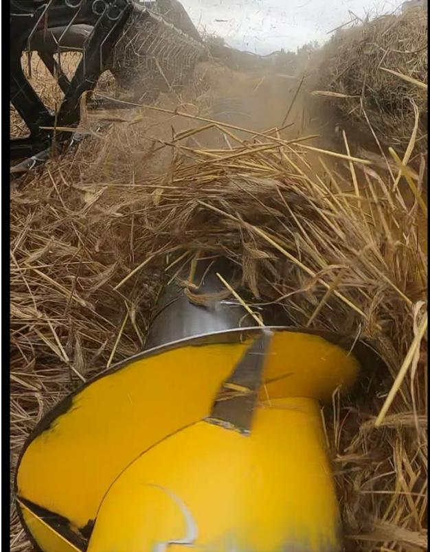
**LIMITS!** Ungleichmäßigen Vorschub gibt es bei mangelnder = diskontinuierlich arbeitender Zwangsführung von beiden Seiten des Schneidwerkes. Der Erntegut Vorschub über die Schneckenwendel, kommt unter der rückwandigen Abstreif- leiste immer wieder zum Stocken.
