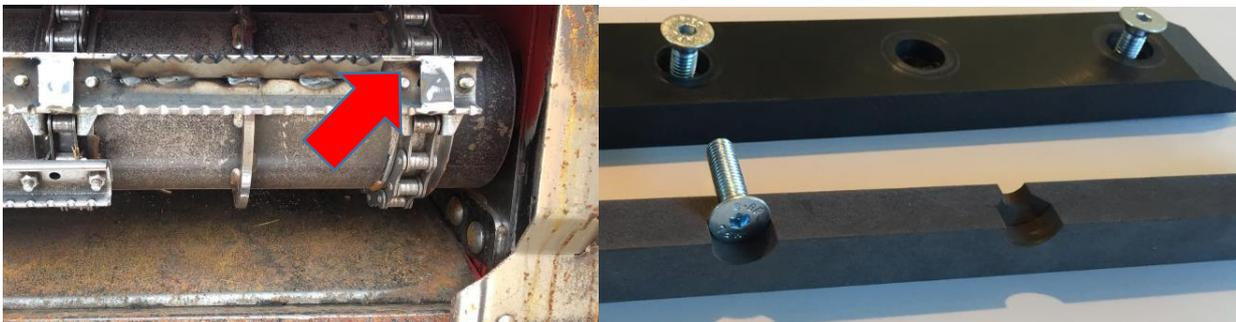
**Gleitplättchen** (Foto oben links, s. Pfeil) und bei Förderleisten mit zu geringem Abstand zum Förderboden werden gleichzeitig **Gleitkufen** (Foto oben recht: 5cm breit, 2cm hoch, 40cm lang) verbaut.
