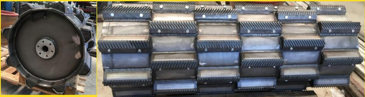
U. a. für Deutz-Fahr/DF 6-Schüttler Mähdrescher. Praxis erprobt- mit Zertifikat gewuchtet! Beispiel DF-Trommel: 48 = 8x6 versetzte, abschraubbare Dreschbacken; Trommel-Durchmesser: 60cm. Die 400 kg Schwungmassen schwere Trommel treibt unaufhaltsam den Durchzug des Erntestranges an, ähnlich einem Schwungrad.
