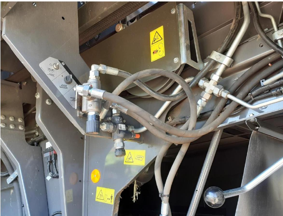
**Agri-Broker liefert –als OPTION- folgenden 3-Wege Stromregler, mit Druckkompensation und Überdruckventil, bis max. 270 bar – in Aluminium Gehäuse: P bis 280 l/min; C = bis 190 l/min – 1“ GAS:**
