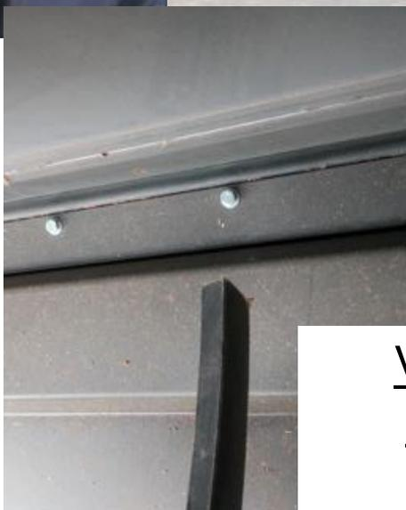
Verteilriemen arbeiten dicht vor der Abgangskante des Strohrutschbleches !
