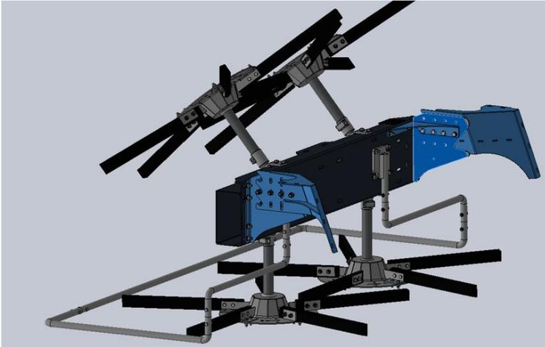
Der **Agri-Broker Sicherheitsbügel** wird auf der Rückseite des Heckverteiler Querträgers angebracht, an eine eigene Halterung, links und rechts.
