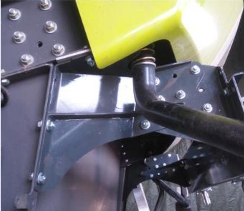
Mit der Montage haben Sie sichergestellt, dass die Verteilriemen bis dicht vor die Abbruchkante des Übergaberutschbleches reichen.
