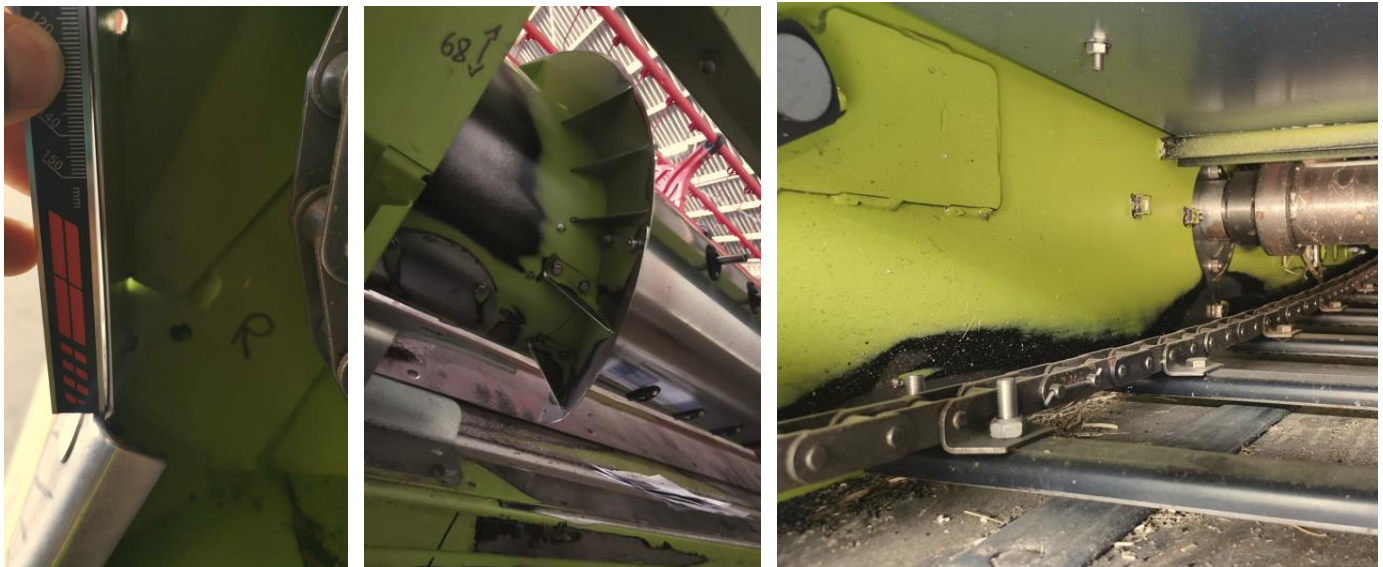
FOTO LINKS: Gewalttätige aufgeklatschte Überlasten drücken das „Schutzblech“ ein; FOTO MITTE: zeigt den seitlichen Aushub- =Überlastbereich; FOTO RECHTS: die Farbab- riebe zeigen den durch Überlast produzierten Wellen förmigen Rauzug des Erntestranges.
