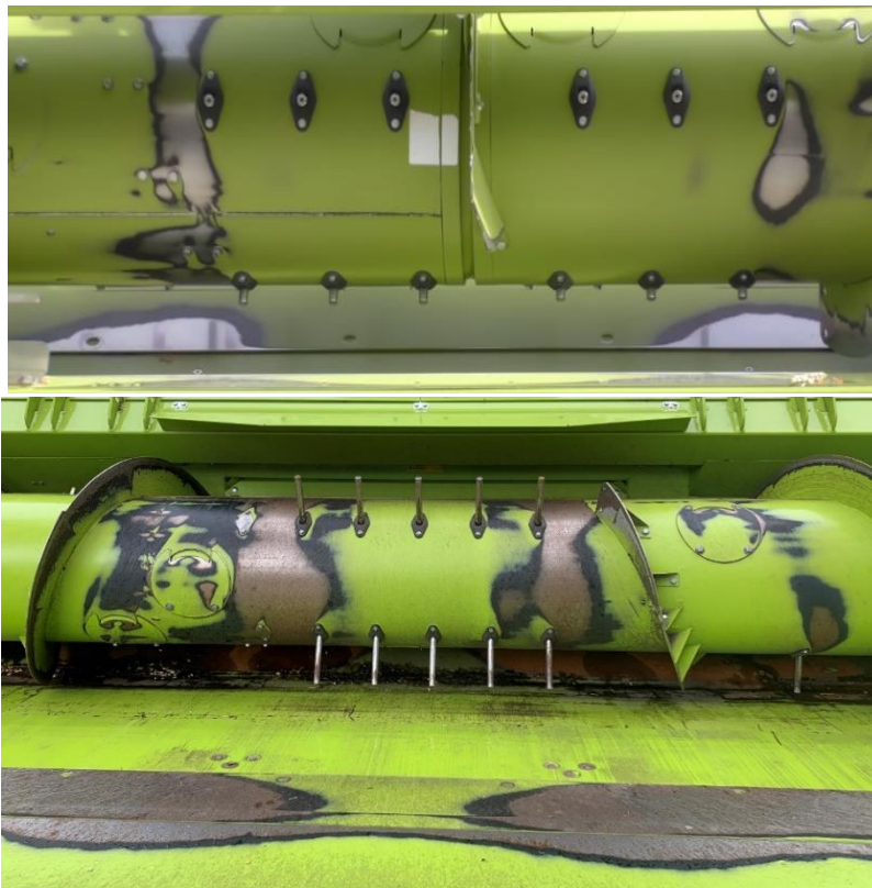
OBEN: am Ende wird der Schneckenwendel von 12cm Höhe auf 11cm runtergesetzt Was passiert dabei?!
