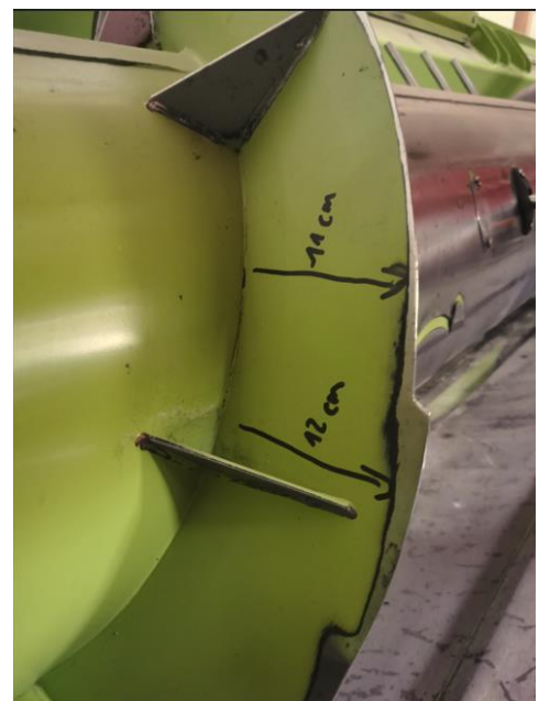
OBEN: am Ende wird der Schneckenwendel von 12cm Höhe auf 11cm runtergesetzt Was passiert dabei?!
