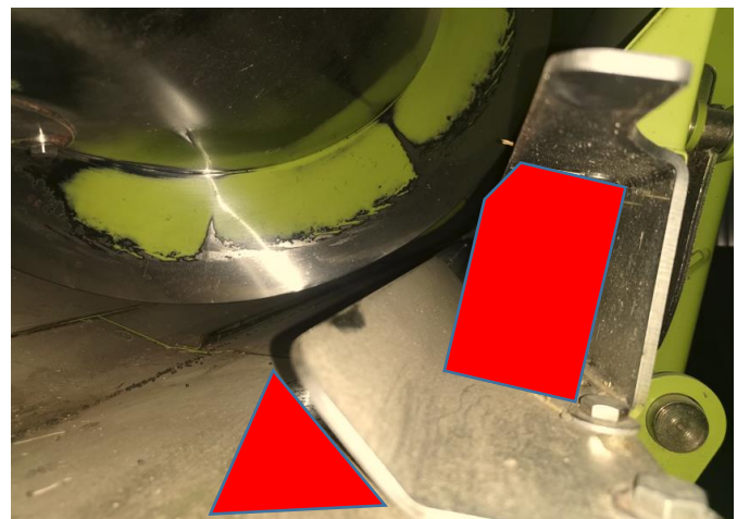
Tote Ecken, in denen das Erntegut, da reingestopft (=Überlasten) kontinuierlich nicht fließen kann.
