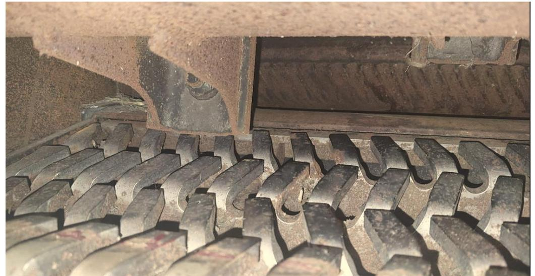
**ZWECKE:** a.) kontinuierliche Durchleitung zum Dreschspalt; b.) bei Mais weitere Lockerung der Lieschblätter; c.) leicht-mittelstark dreschende Ähren werden teilweise aufgelöst; c.) vorgezogene sofortige ABSCHIEDUNG, aller bereits im Schrägförderer Ähren herausgelöster Körner (s. Agri-Broker Schrägförderer Ährenaufkösplatte), daraufhin Entlastung des Dreschkorbes und der Restkornabscheidung;
