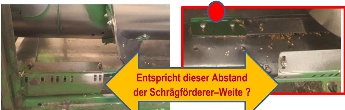
Oben: im Nachhinein neu montierte, grün lackierte Verlängerungsleisten, der vorderen Abstreifleiste, dank derer mehr Erntegut bis zur Schneidwerksmitte vordringen kann.
