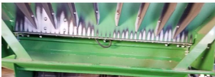
Dank mangelhafter Beschickung über das Schneidwerk nutzen diese Schrägförderer nur ca. 50-70% der Förderbreite:
