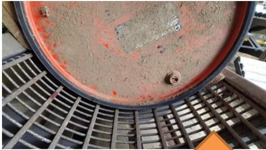
Da der Erntestrang in der Dicke nicht gleichmäßig durchgezogen werden kann, ist der konvexe Korb am Ein- & Ausgang kontraproduktiv, in der Mitte presst dieser zu dicht. Der dadurch verspätete Körnerdrusch scheidet die Körner in der hinteren Korbhälfte spät aus. Was Schüttlerverluste nach sich zieht.
