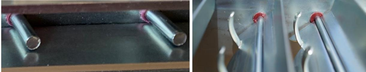
Agri-Broker Siebe können auch wie folgt ausgestattet sein: die Lamellendrahtenden werden unter der oberen U-Profilfläche eng anliegend so herausgeführt, dass der obere Drahtbereich am Seitenprofil anliegt, sodass dieser nur noch geringe – keine Vibrationen (Verschleiß) mehr macht.
