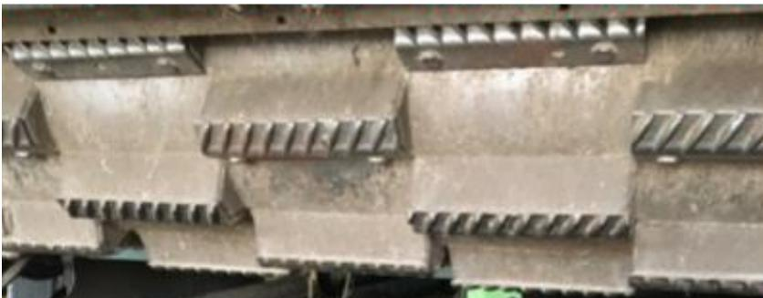
**Mit versetzten, abschraubbaren Dreschleisten:
