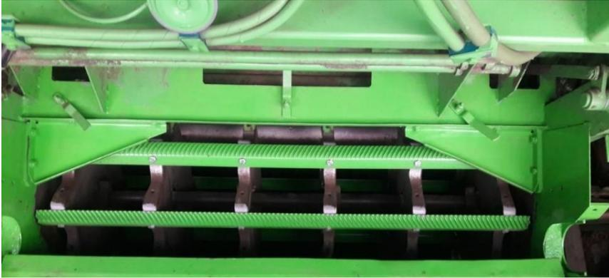
**sowie 8 Stück Beschwerungs-Luftleitplatten zur Erhöhung der Schwungmasse um 65 kg: verbessert die SELBSTREINIGUNG und die SCHWUNGMASSE DER TROMMEL.**
