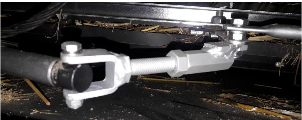
Bei Bedarf: Gabel-Justiergewinde Verbindungsstück vom Elektromotor - Zubringer zum manuellen Hebel des AB. Untersiebes.
