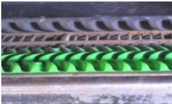
Der Erntestrang wird auf den GDL kurz überpresst – die unmittelbar herausgelösten Körner landen zwischen den Stängeln und schießen aus dem Korb, der als Abscheidekorb arbeitet, massiv raus – zur Entlastung der Schüttler.
