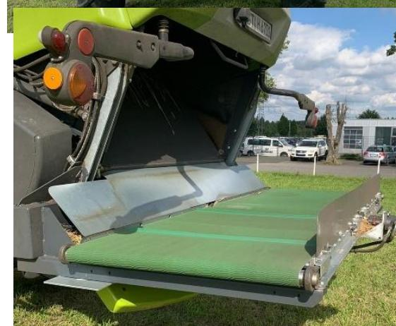
Zum Straßentransport wird dieser Verteiler hochgeklappt:
